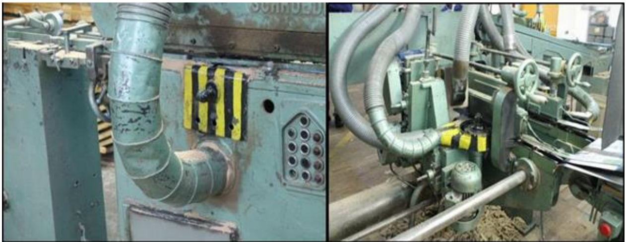
Slika 4: Lokalna ventilacija na mjestu stvaranja prašine
