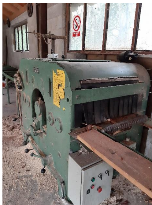
Slika 16: Automatska višelisna kružna pila
