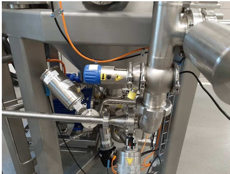
Slika 14. Ventil za uzimanje uzorka (Izvor: D. Novosel).
