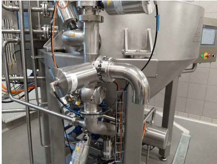
Slika 15. Ispust za gotov proizvod (Izvor: D. Novosel).
