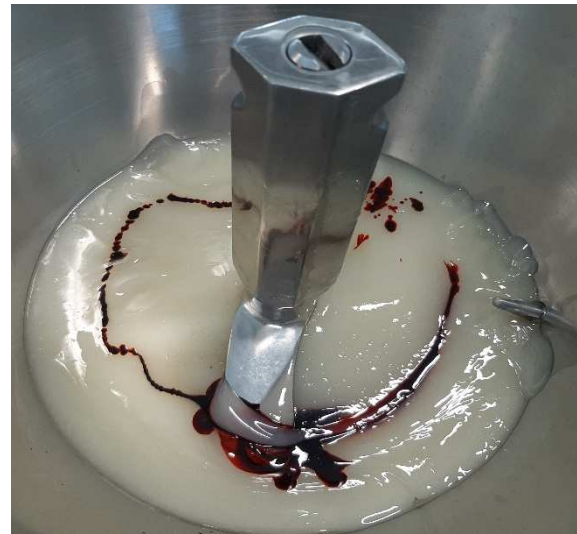
Slika 30. Homogenizirana masnoća (a), dodani ekstrakt paprike (b) (Izvor: D. Novosel).
