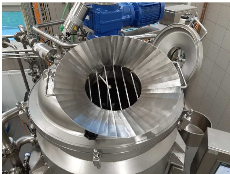
Slika 4. Lijevak za ubacivanje sirovina koje iziskuju nježniji tretman (Izvor: D. Novosel)
