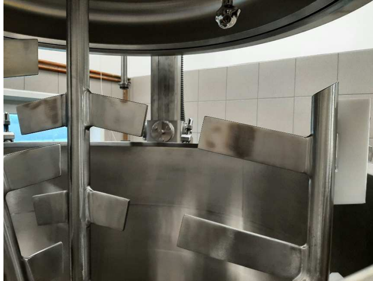
Slika 5. Sidro za nježno miješanje (Izvor: D. Novosel).
