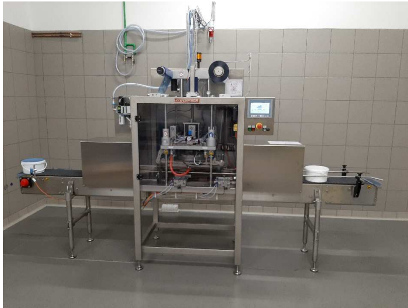
Slika 11. Uređaj za zatvaranje kantica pomoću folije tvrtke Miromatic SIG-1 VEA 1/10.
