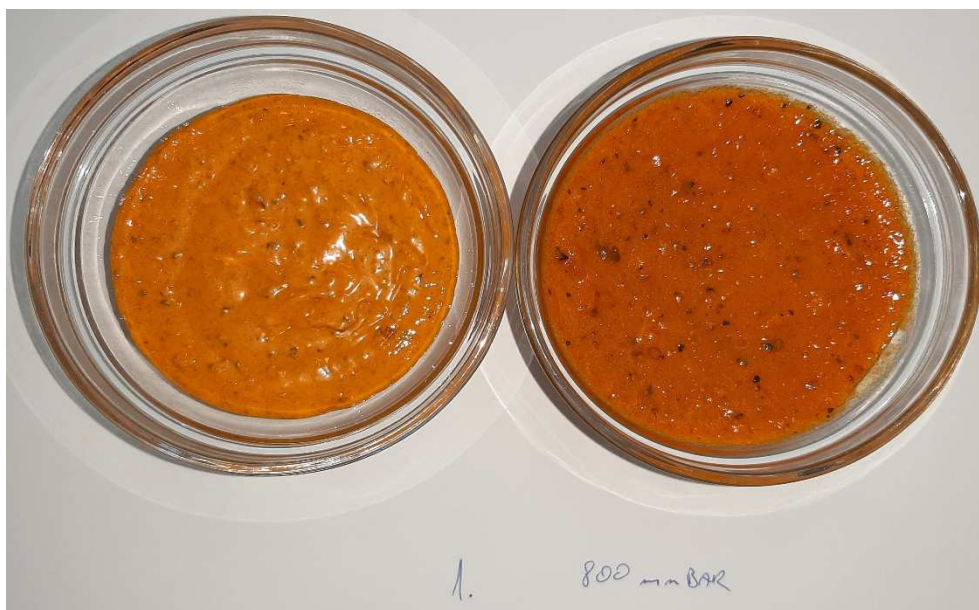
Slika 49. Prikaz kontrole vakuuma za uzorak broj 1. lijevo originalni uzorak broj 1, desno uzorak broj 1. dodatno vakumiran na 0,8 bar pri temperaturi 24°C.
