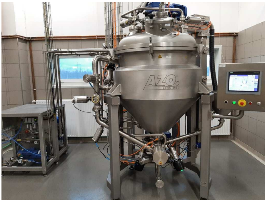
Slika 1. Mješač tvrtke AZO Liquids GmbH BG 400 (Izvor: D. Novosel).
