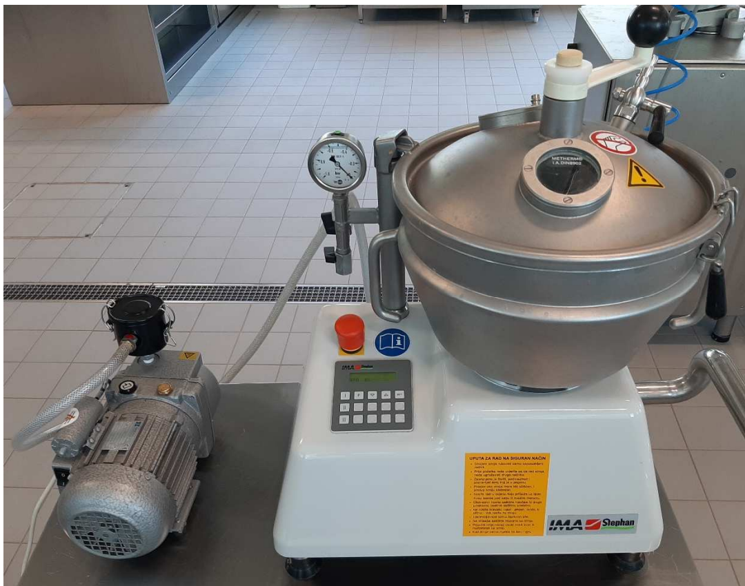
Slika 28. Stephan UMC 12 sa eksternom Vakuum pumpom (Izvor: D. Novosel)
