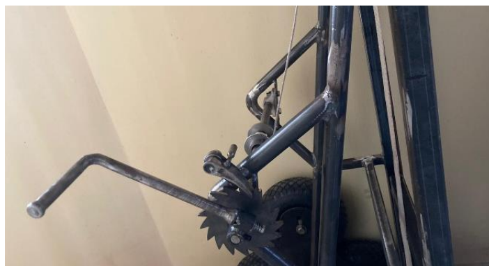
Slika 30. Izvedba sklopive ručke - radni položaj (namatanje)
