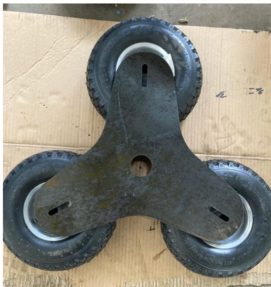
Slika 23. Postupak spajanja kotača i zvijezda
