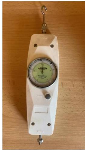
Slika 33. Dinamometar za provođenje ispitivanja (max. 500 N \pm 1%)
