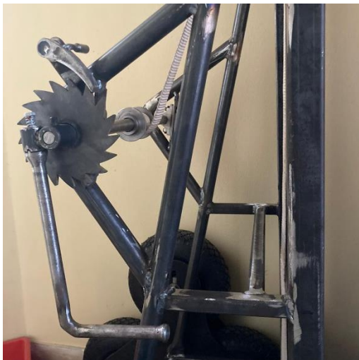
Slika 31. Izvedba sklopive ručke - (vožnja)
