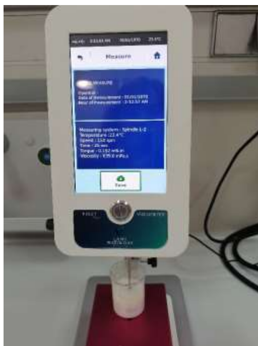
Slika 19. Mjerenje viskoznosti rotacijskim viskozimetrom (Izvor: I. Štiglić).
