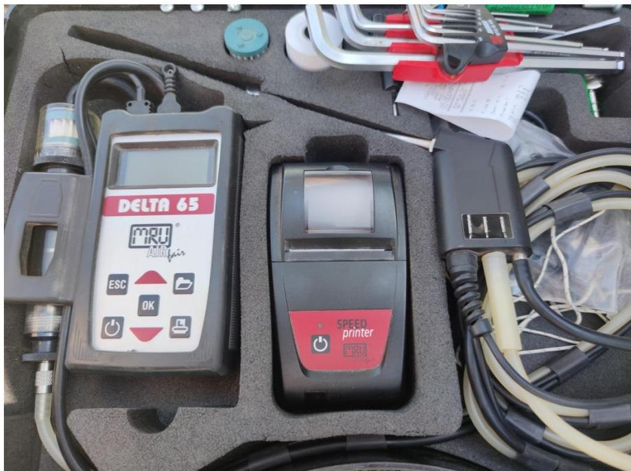
Prilog 7: Aparat za mjerenje izlaznih plinova
