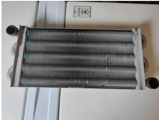
Slika 4: Primarni izmjenjivač topline
