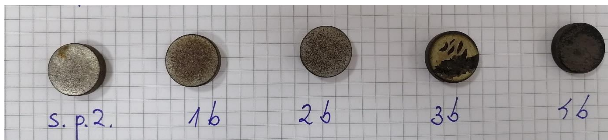
Slika 32: Uzorci brušenog čelika nakon 2h djelovanja 5% otopine HCl
