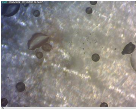
Slika 42: Površine brušenog čelika s Premazom 2 snimljene optičkim metalografskim mikroskopom prije i nakon izlaganja djelovanju 5% otopine HCl u trajanju od 2 h na 25 °C
