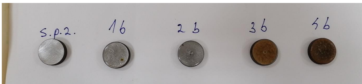
Slika 29: Uzorci čelika prije (sp2-brušeni) i nakon nanošenja i sušenja premaza 1 (1b), premaza 2 (2b), premaza 3 (3b) i premaza 4 (4b)
