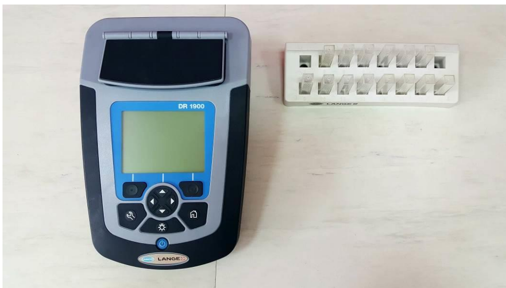
Slika 26: Prijenosni spektrofotometar Hach Lange
