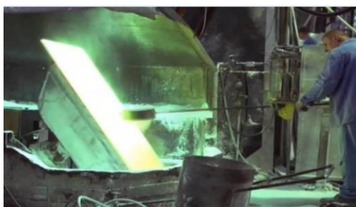
Slika 13: Postupak emajliranja kade od lijevanog željeza [20]
