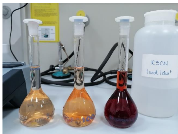
Slika 27: Pripremljene otopine za određivanje sadržaja željeza spektrofotometrijski
