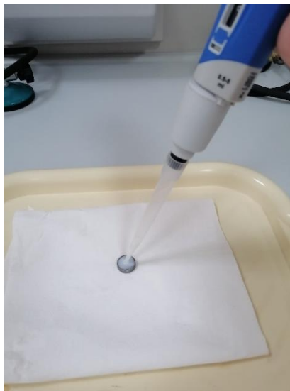
Slika 25: Nanošenje premaza na površinu uzorka čelika
