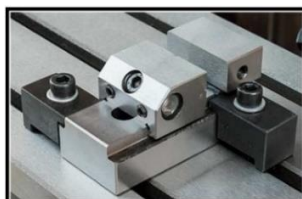
Slika 43. Strojne stezaljke (tamno sivi elementi)
