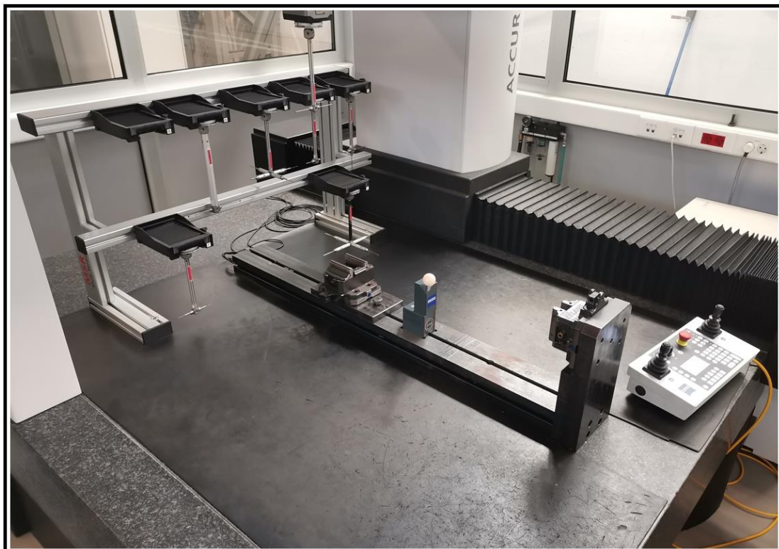
Slika 40. Izgled poboljšane naprave na CMM uređaju
