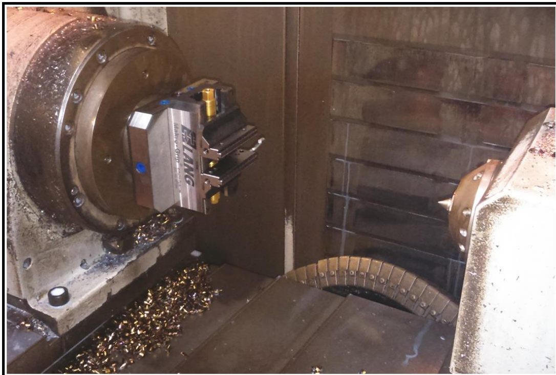
Slika 37. HSK80 + LANG Zero-Point u stroju
