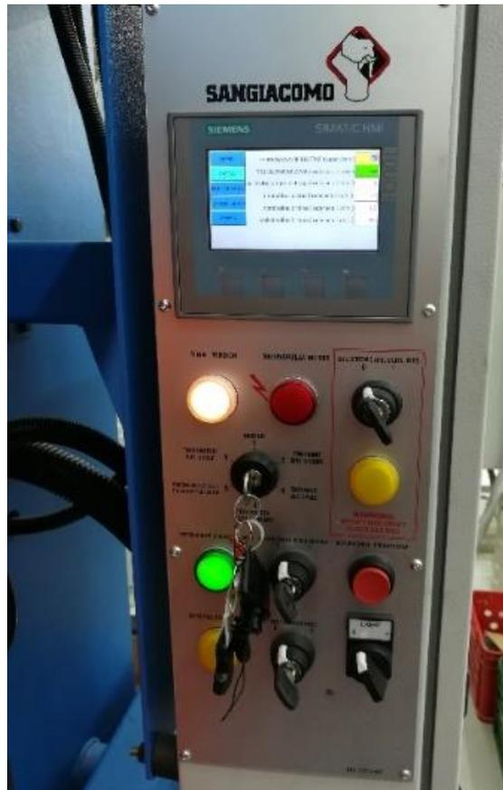
Slika 61 Predodžba upravljačke jedinice preše.
