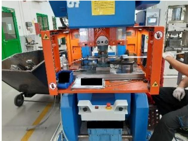
Slika 52 Predodžba ručnog posmaka trake.
