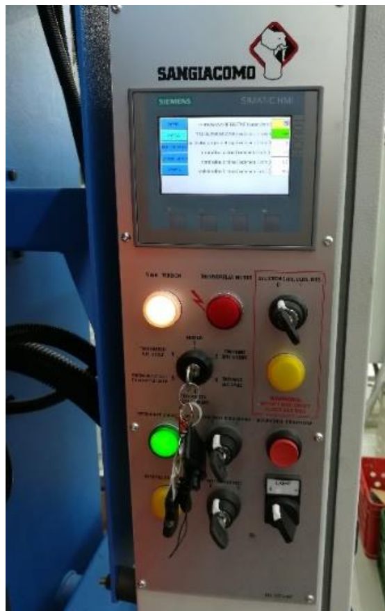
Slika 61 Predodžba upravljačke jedinice preše.
