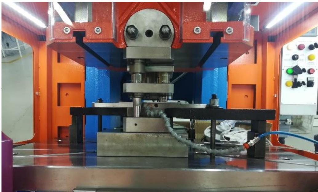
Slika 59 Predodžba ispuhivanja platina kroz alat.
