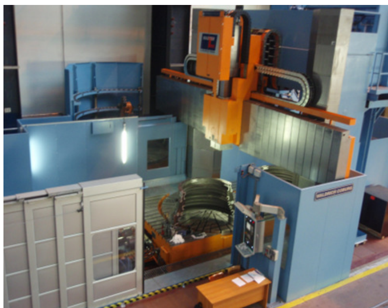
Slika 4.1 Obradni centar Waldrich Coburg MasterTec 4500 AT
