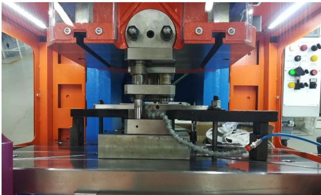
Slika 59 Predodžba ispuhivanja platina kroz alat.
