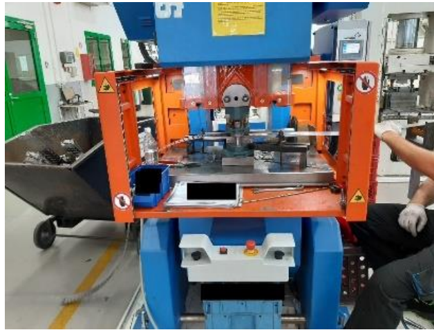
Slika 52 Predodžba ručnog posmaka trake.
