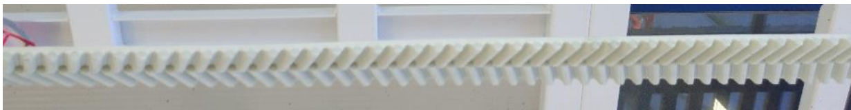
Slika 7. Samo-centrirajući zupčasti remen
