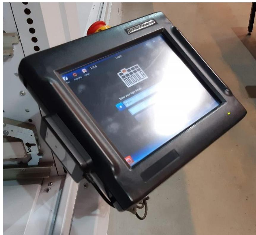
*Slika 16. RFID čitač pričvršćen na stranu industrijskog panela*
