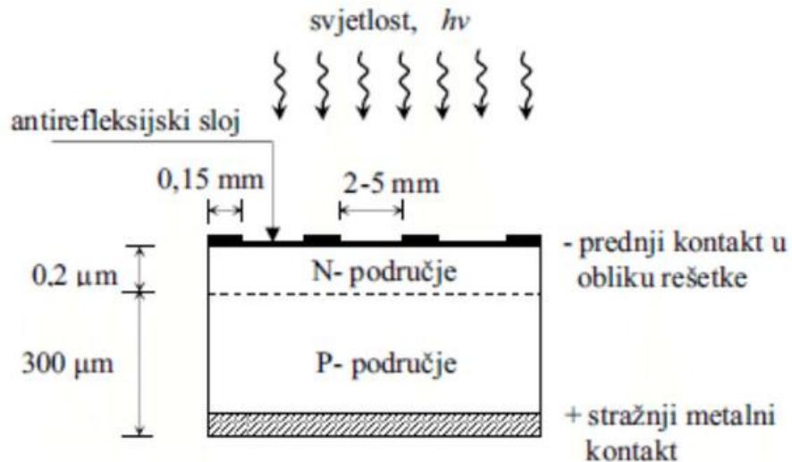
Slika 3. Shematski prikaz PN solarnih ćelija [4]
