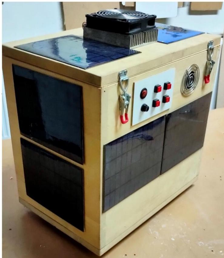
Slika 13. Raspored solarnih panela [11]
