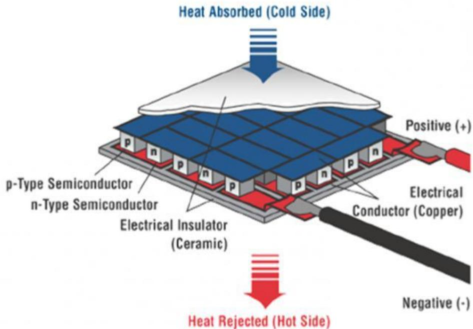
Slika 2. Prikaz rasporeda P N spoja u elementu [2]
