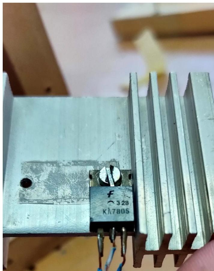
Slika 12. Regulator napona 7805 na aluminijskom hladnjaku [11]
