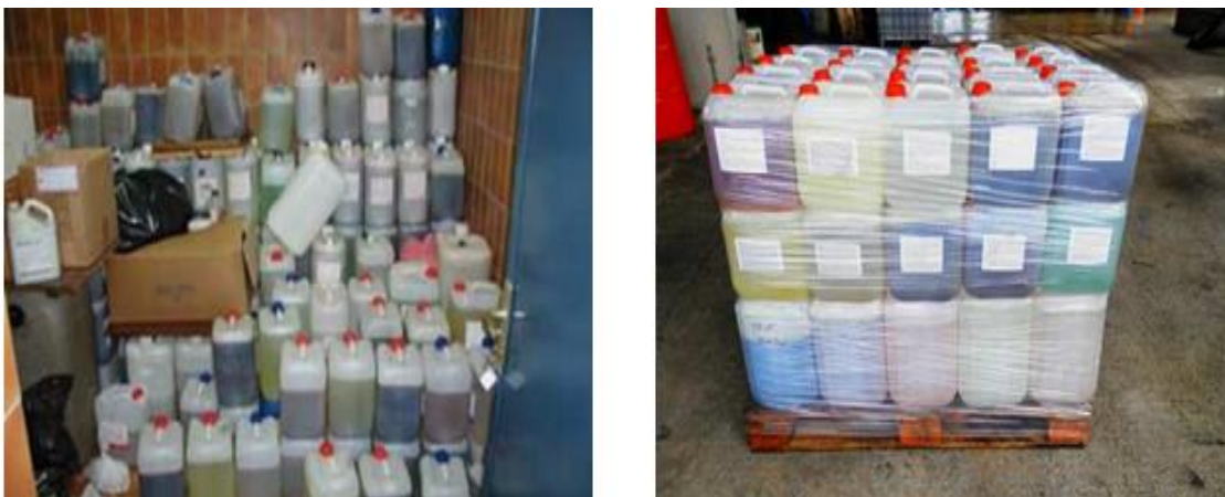
Slika 8. Skladištenje otpada nepodudarnih kemijskih svojstava [21]
