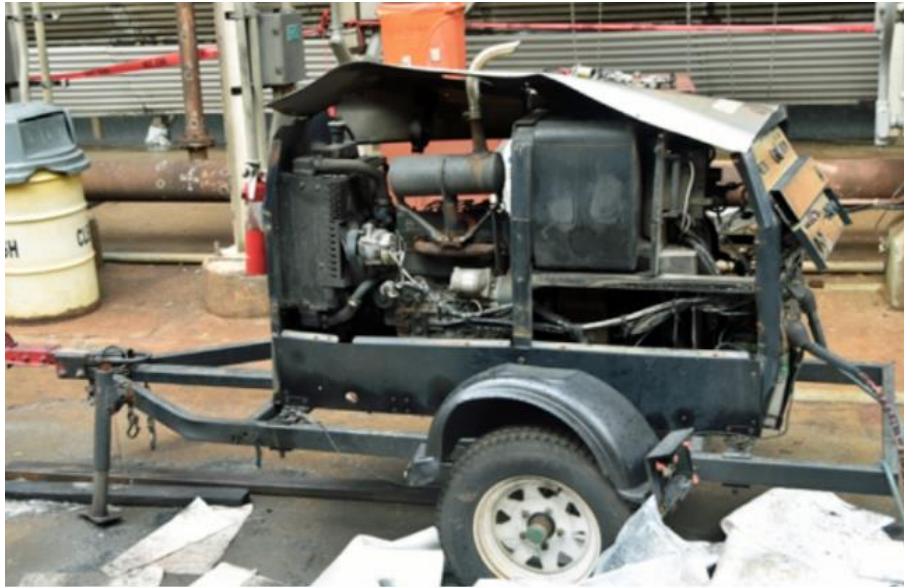
Slika 9. Uređaj za zavarivanje koji je uzrokovao požar [23]
