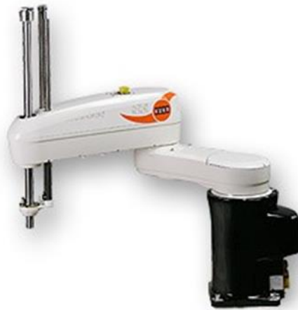
Slika 10. Montažna robotska ruka selektivne usklađenosti [12]
