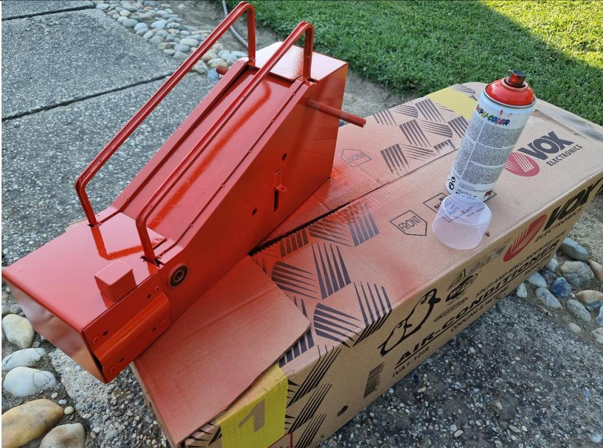
Slika 25. Bojanje kućišta.
