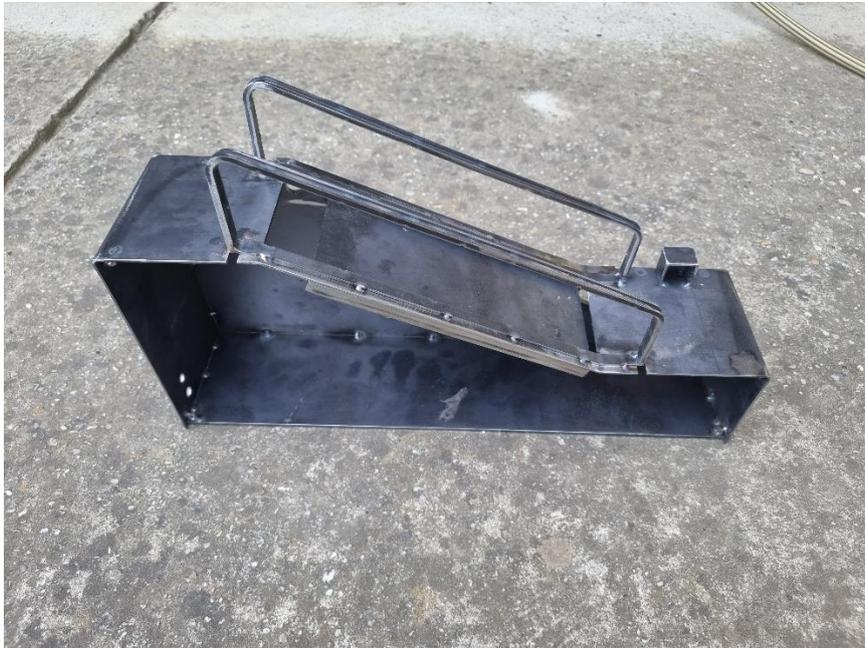
Slika 23. Zavareno kućište.
