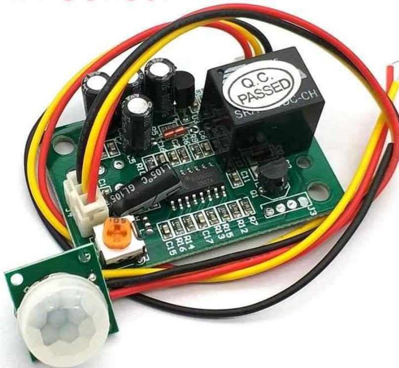
Slika 30. TAD-758 Relej s pir senzorom. [10]
