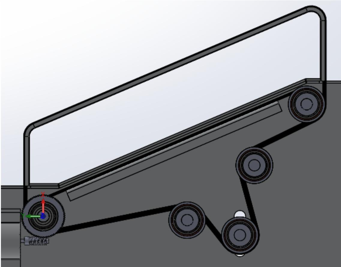
Slika 27. Pogonski mehanizam.
