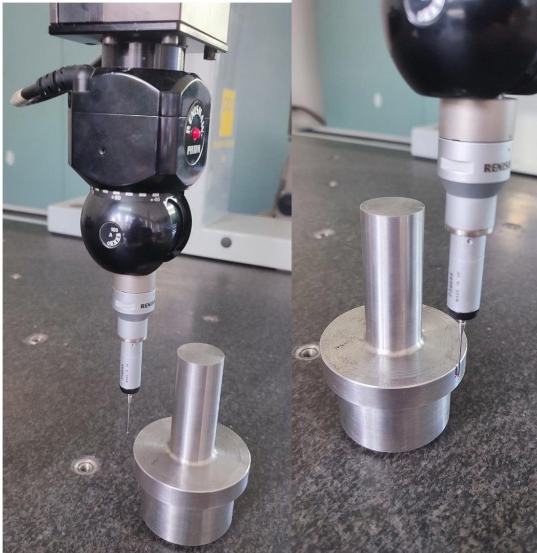
Slika 27 Predodžba prikaza mjerenja promjera. Izvorno autor.
