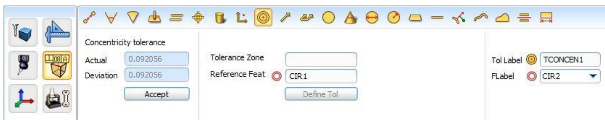
Slika 46 Predodžba funkcije prikaza koncentričnosti. Izvorno autor.
