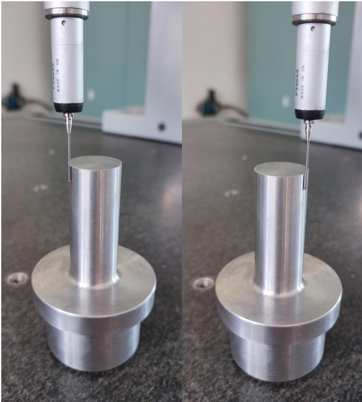
Slika 29 Predodžba mjerenje promjera 26. Izvorno autor.
