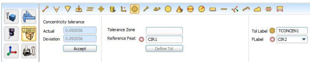
Slika 46 Predodžba funkcije prikaza koncentričnosti. Izvorno autor.
