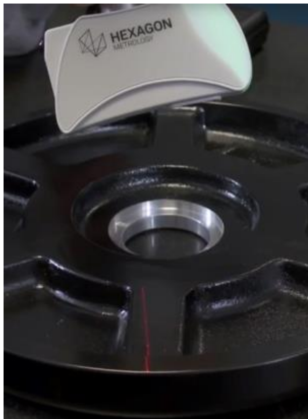
Slika 15 Primjer laserskog skenera u metrologiji
