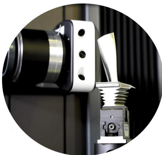
Slika 13 Primjer beskontaktnog senzora sa bijelim svjetlom
