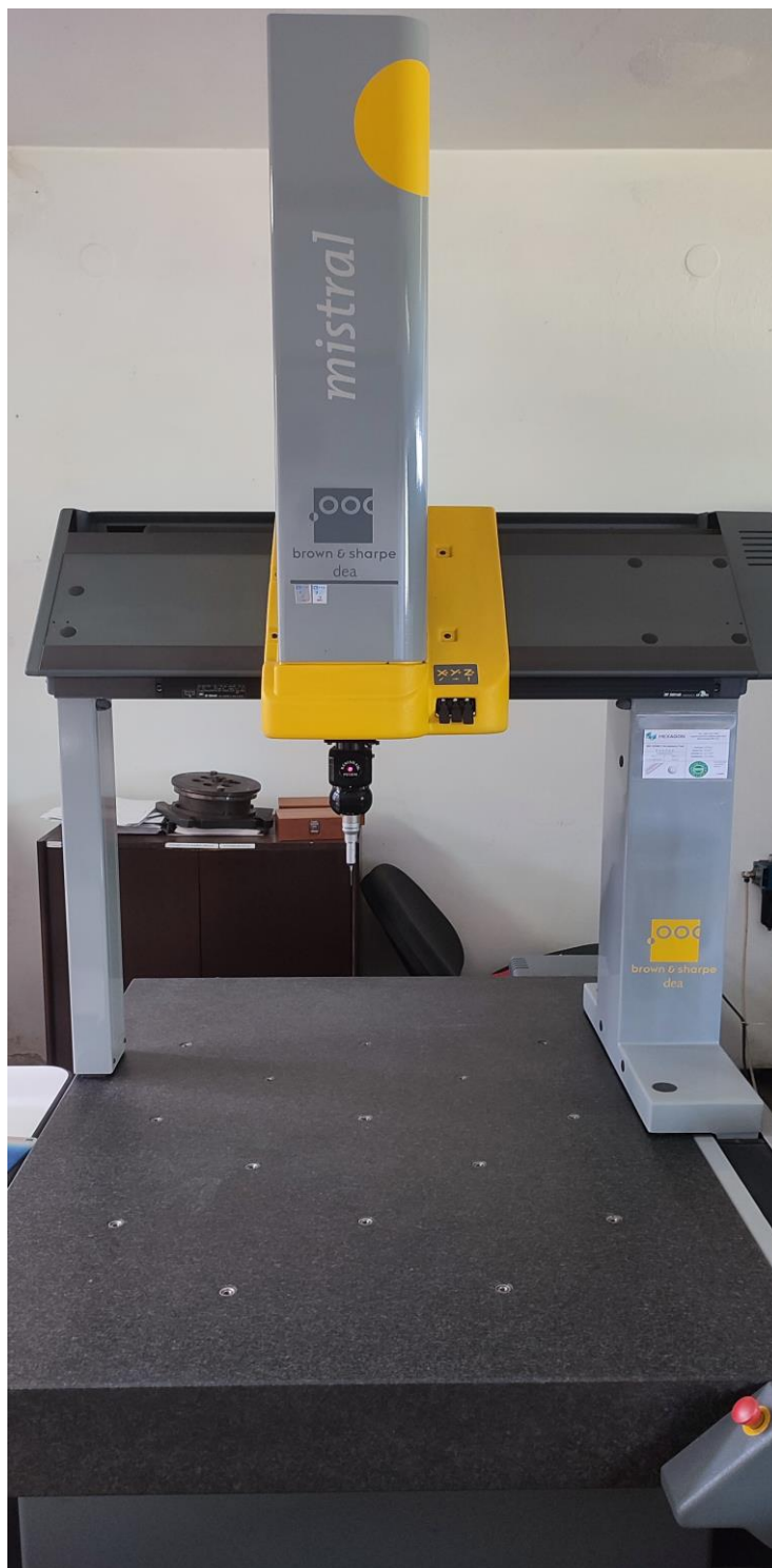
Slika 19 Predodžba mjernog uređaj Dea Mistral. Izvorno autor.
