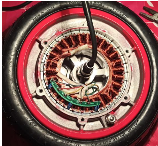
Slika 16- Unutrašnjost BLDC motora sa vidljivim magnetima rotora i namotom armature
