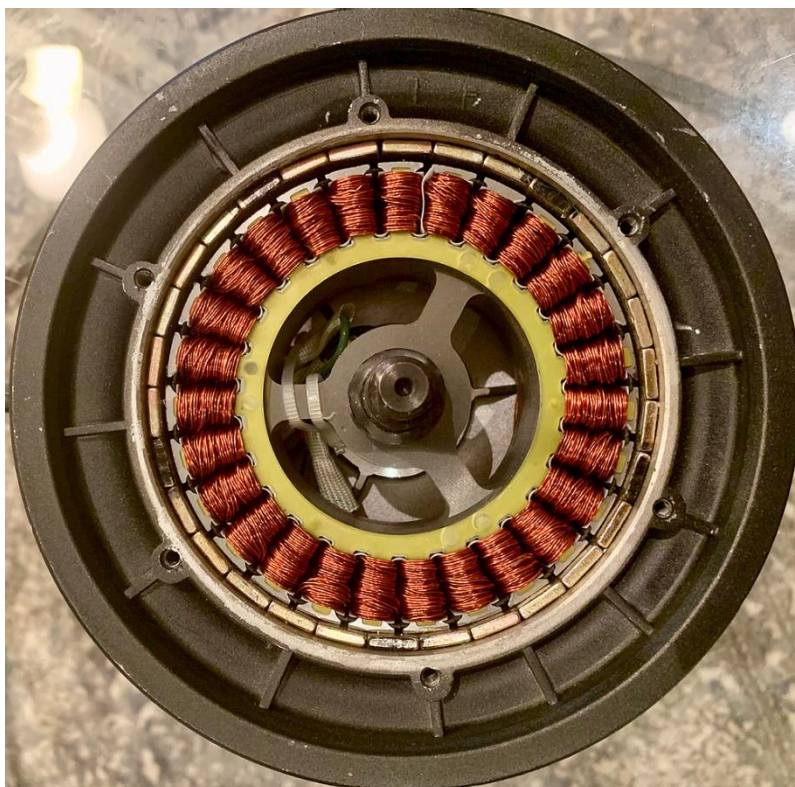
Slika 4 - Bezčetkični motor ugrađen u glavčinu kotača
