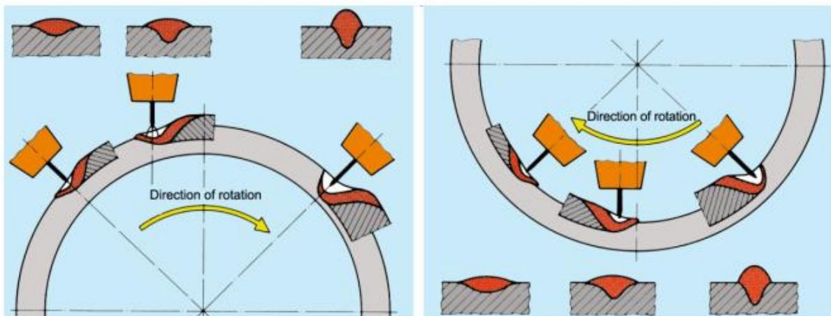
Slika 24. Utjecaj položaja zavara (kuta zavarivanja) na geometriju zavarivanja pri okretaju cijevi [4].
