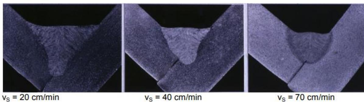
Slika 15. Utjecaj brzine zavarivanja na profil varu pri izradi kutnih zavara.
