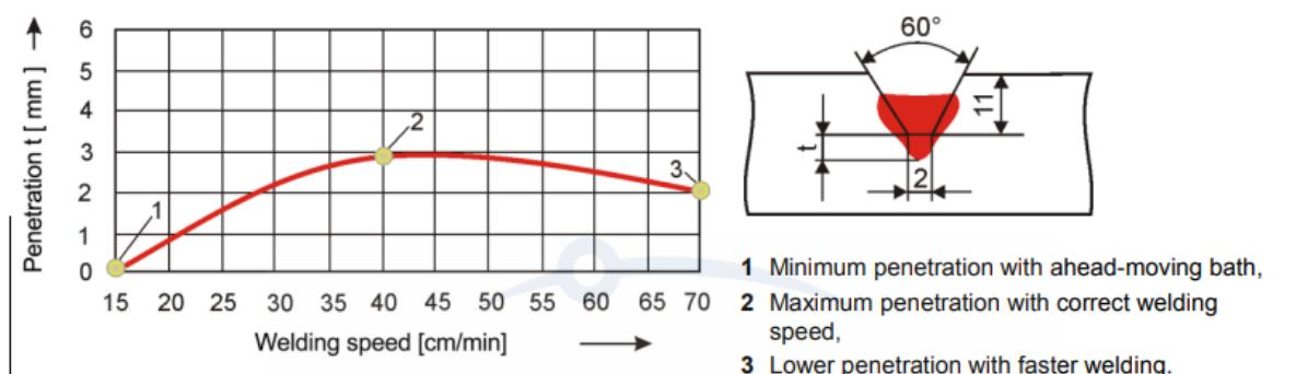
Slika 16: Utjecaj brzine zavarivanja na dubinu prodiranja [4].
