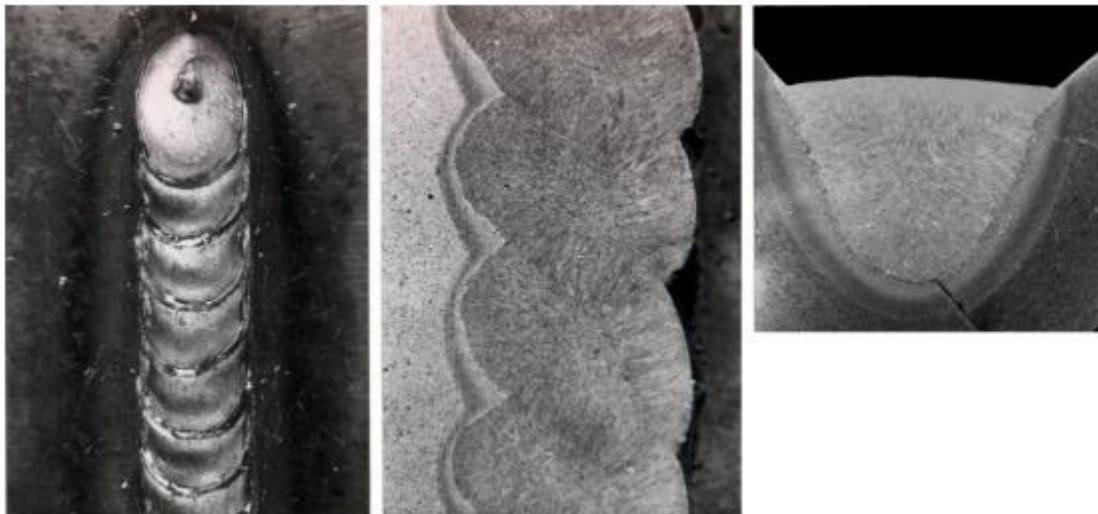
Slika 26. Zavar okomit prema gore, potpuno mehaniziran, zavarivan u intervalima;  $a = 4.5 \text{ mm}$  [4].
