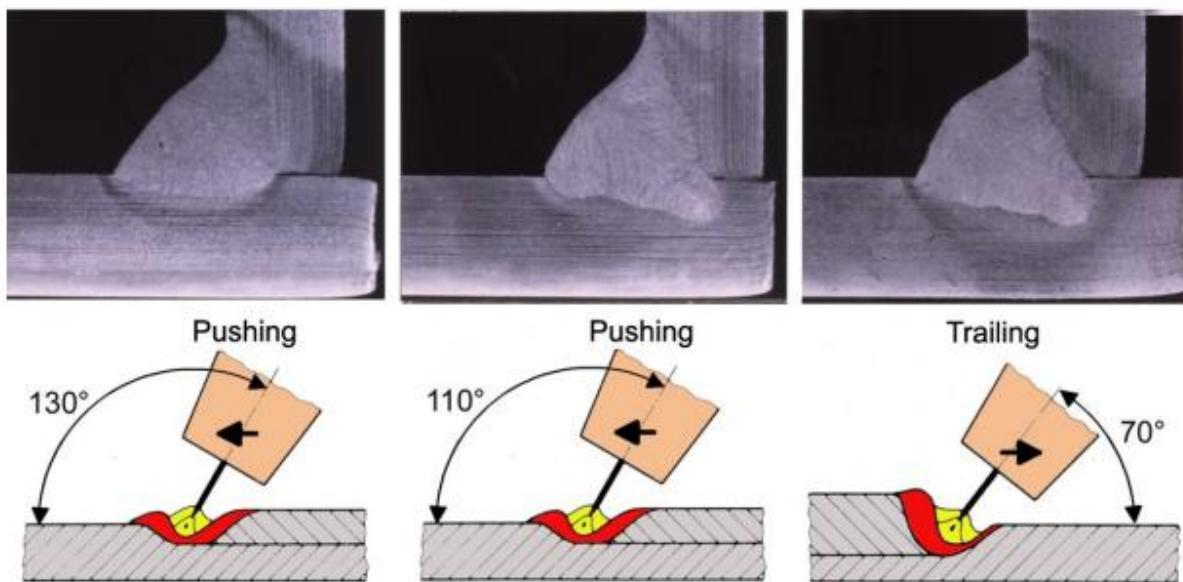
Slika 20. Utjecaj tehnike rada na profil varu pri izradi kutnih zavara [4].
