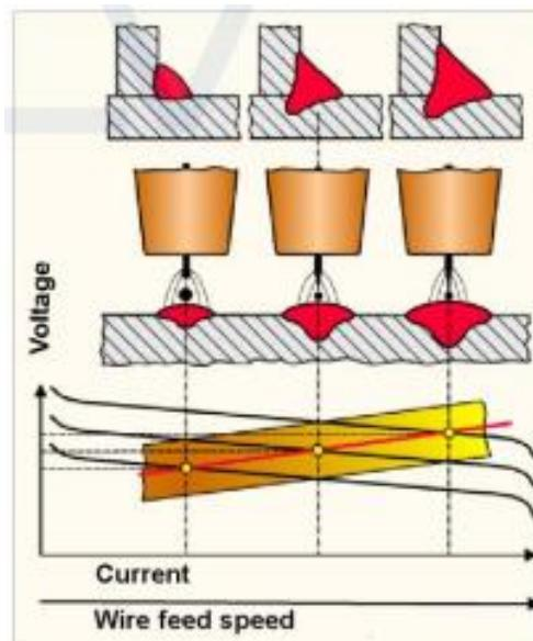
Slika 8. Kretanje radnih točaka prema karakteristikama luka istovremenim ravnjanjem statičkih karakteristika i brzine dodavanja žice [4].
