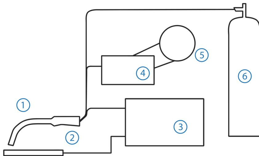
Slika 4. Prikaz opreme za zavarivanje MIG i MAG postupkom:
