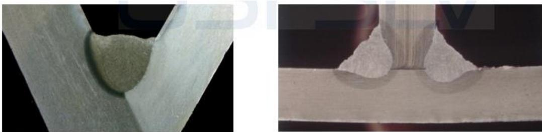
Slika 21. Zavari okomiti prema dolje bez grešaka na konstrukcijskom čeliku sa zaštitnim plinom CO<sub>2</sub> [4].
