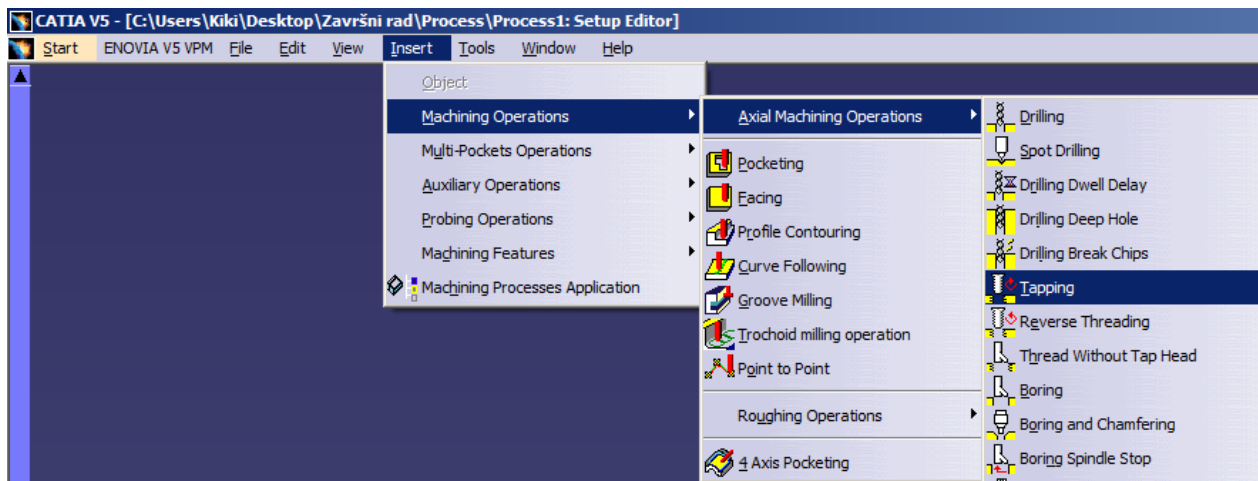
Slika 58. Odabir naredbe za urezivanje navoja
