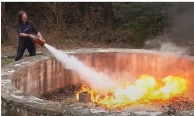
Slika 6. Gašenje požara ugljičnim dioksidom [4]
