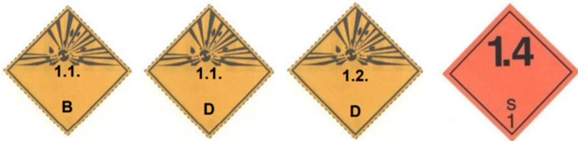
Sl. 13. Listice opasnosti za označavanje pakiranja opasnih tvari Klase 1 [2]
