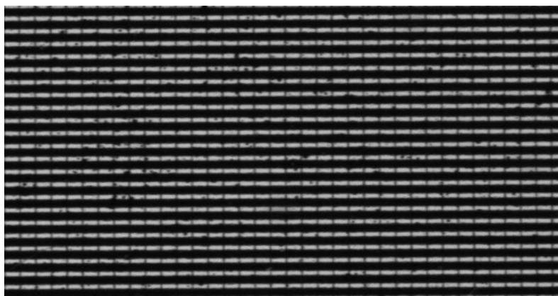
Slika 9. Stari OLED zaslon koji pokazuje potrošenost [13]
