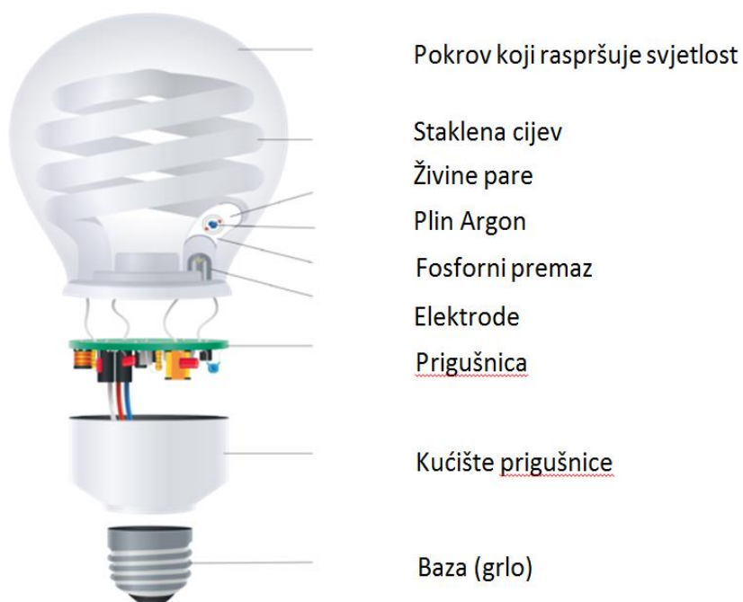
Slika 6: Dijelovi CFL žarulje [27]
