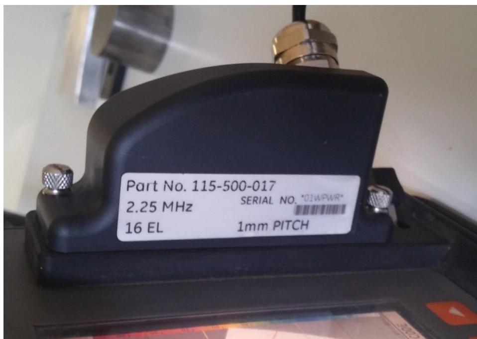
Slika 30. Sonda 2,25 MHz, 16 elemenata
