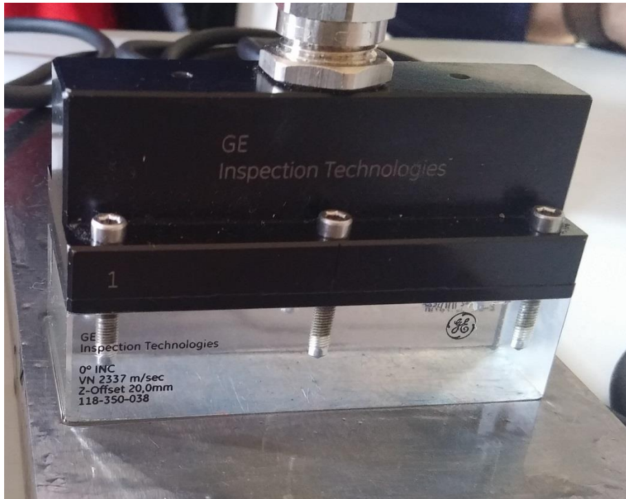
Slika 33. Sonda 5 MHz, 64 elementa
