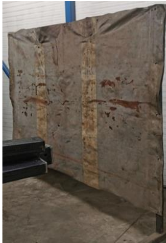
Slika 37. Zaštitna pregrada za zavarivanje
