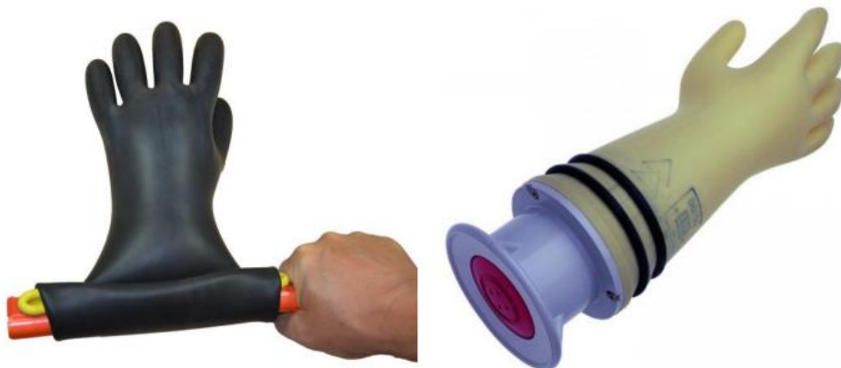
Slika 20. Utvrđivanje ispravnosti izolacijskih rukavica napuhivanjem[15]
