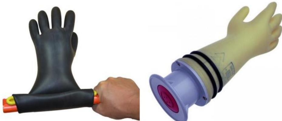
Slika 20. Utvrđivanje ispravnosti izolacijskih rukavica napuhivanjem[15]
