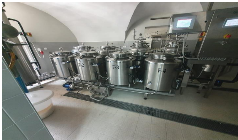
Slika 1. Tankovi za fermentaciju Mikro pivovare Veleučilišta u Karlovcu [1]
