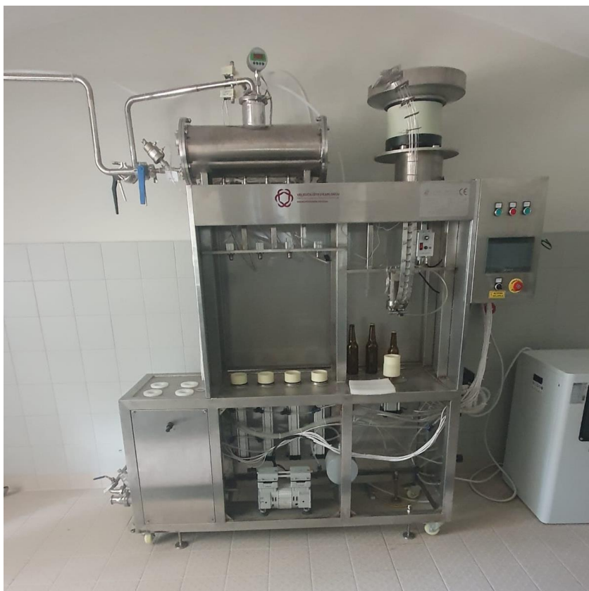
Slika 3. Poluautomatski punjač boca Mikro pivovare Veleučilišta u Karlovcu [3]
