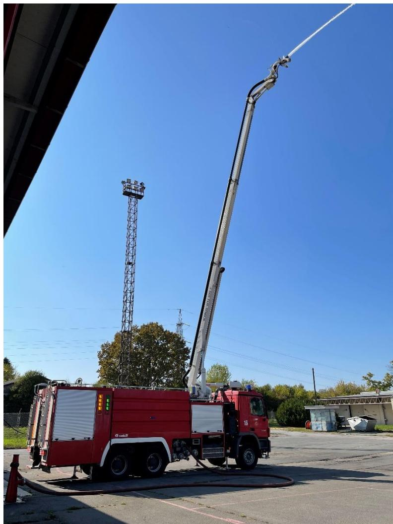
Slika 6. Podignuta hidraulična ruka s monitor bacačem [6]
