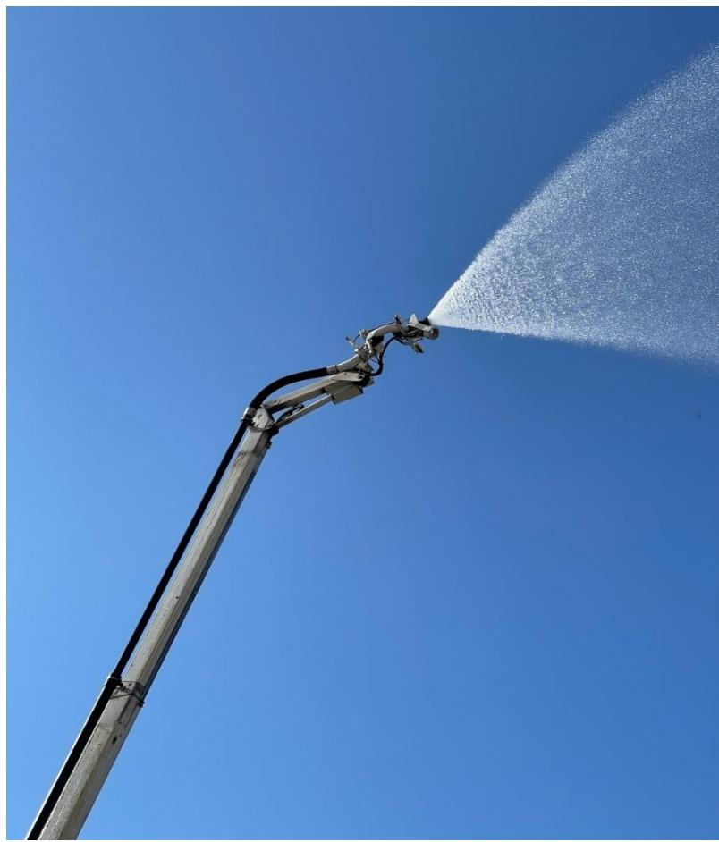
Slika 13. Top-monitor na hidrauličkoj ruci [13]
