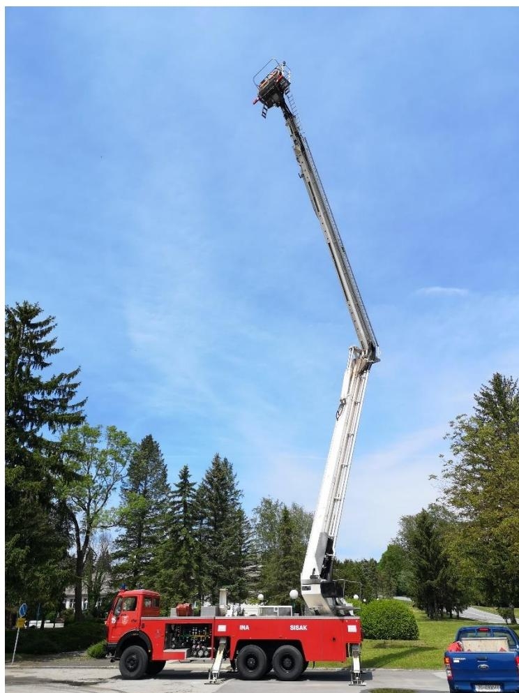
Slika 7. Hidraulična zglobna platforma (SS – 300) [7]
