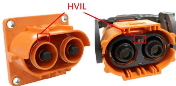
Slika 24. Pinovi HVIL sistema na konektoru za visoki napon [30]
