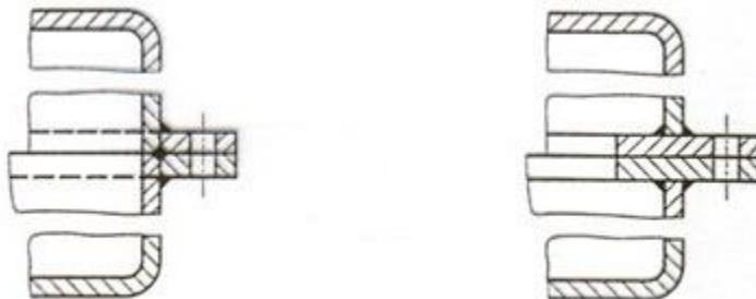
(slika 4-12m) Kod zavarivanja prirubnice brtveni zavar treba postaviti prema unutra.
