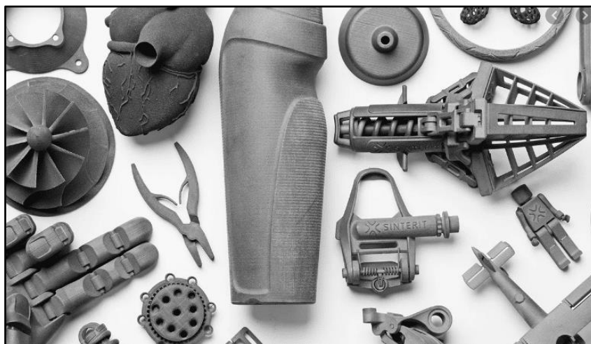
Slika 9. Proizvodi izrađeni SLS postupkom [9]
