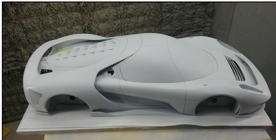
Slika 26. Konceptualni model automobila izrađen aditivnom tehnologijom [28]
