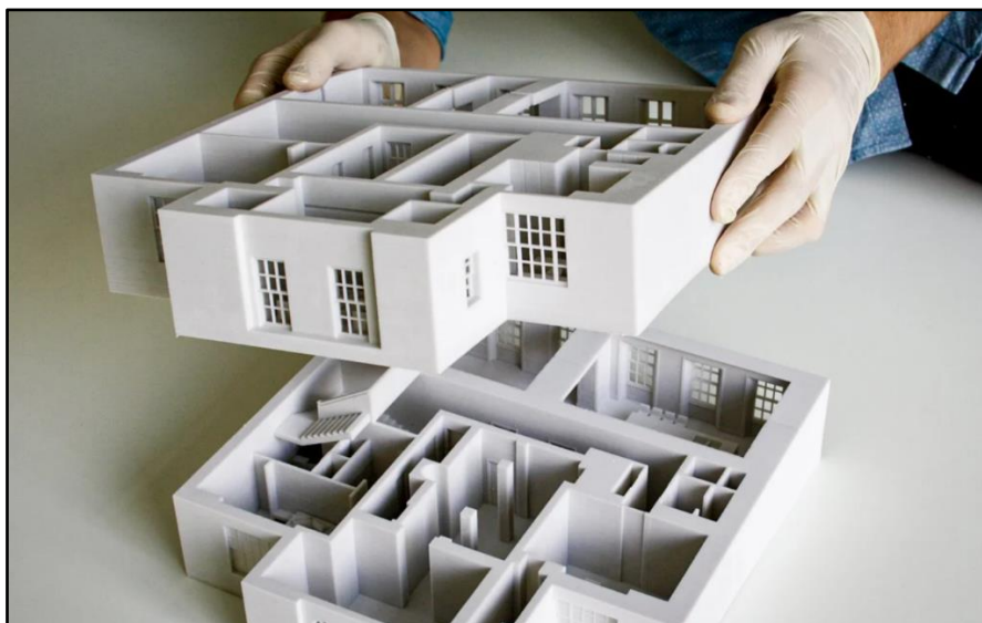
Slika 29. Arhitektonski model izrađen aditivnom tehnologijom [32]
