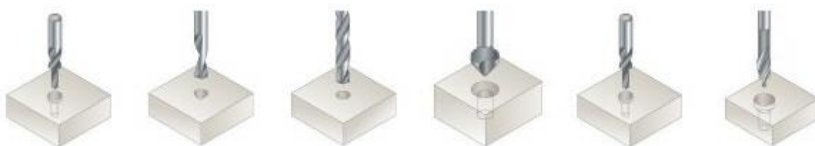
Slika 7. Obrada bušenja, zabašivanja, proširivanja ( razvrtavanja ) i upuštanja rupa [16]
