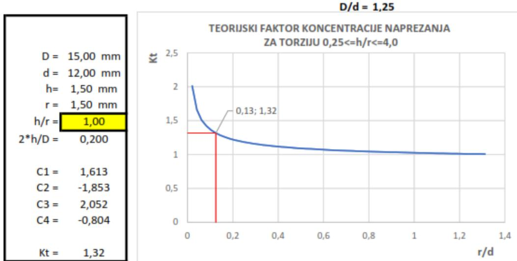
Slika 39. Dijagram krivulje teorijskog faktora koncentracije naprezanja za uvijanje
