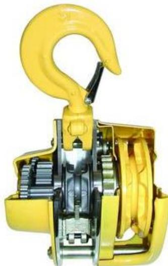
Slika 4. Prikaz unutarnjih djelova ručne lančane dizalice[7]
