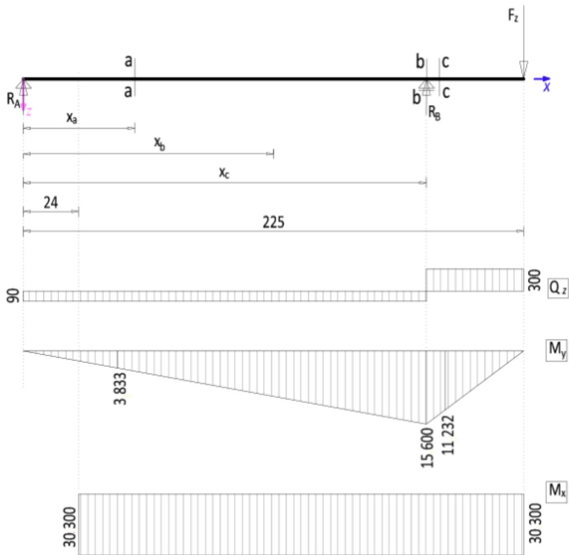
Slika 31. Prikaz unutarnjih sila pogonskog vratila
