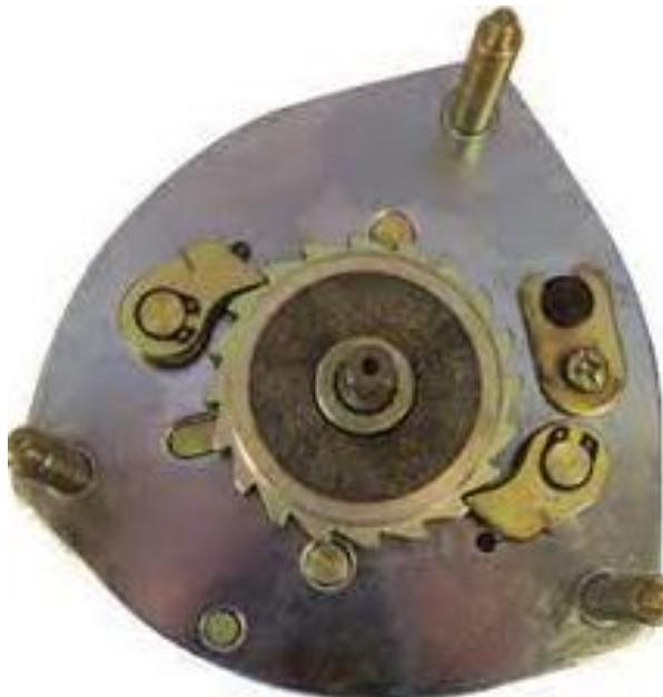
Slika 13. Prikaz kočnog mehanizma[13]
