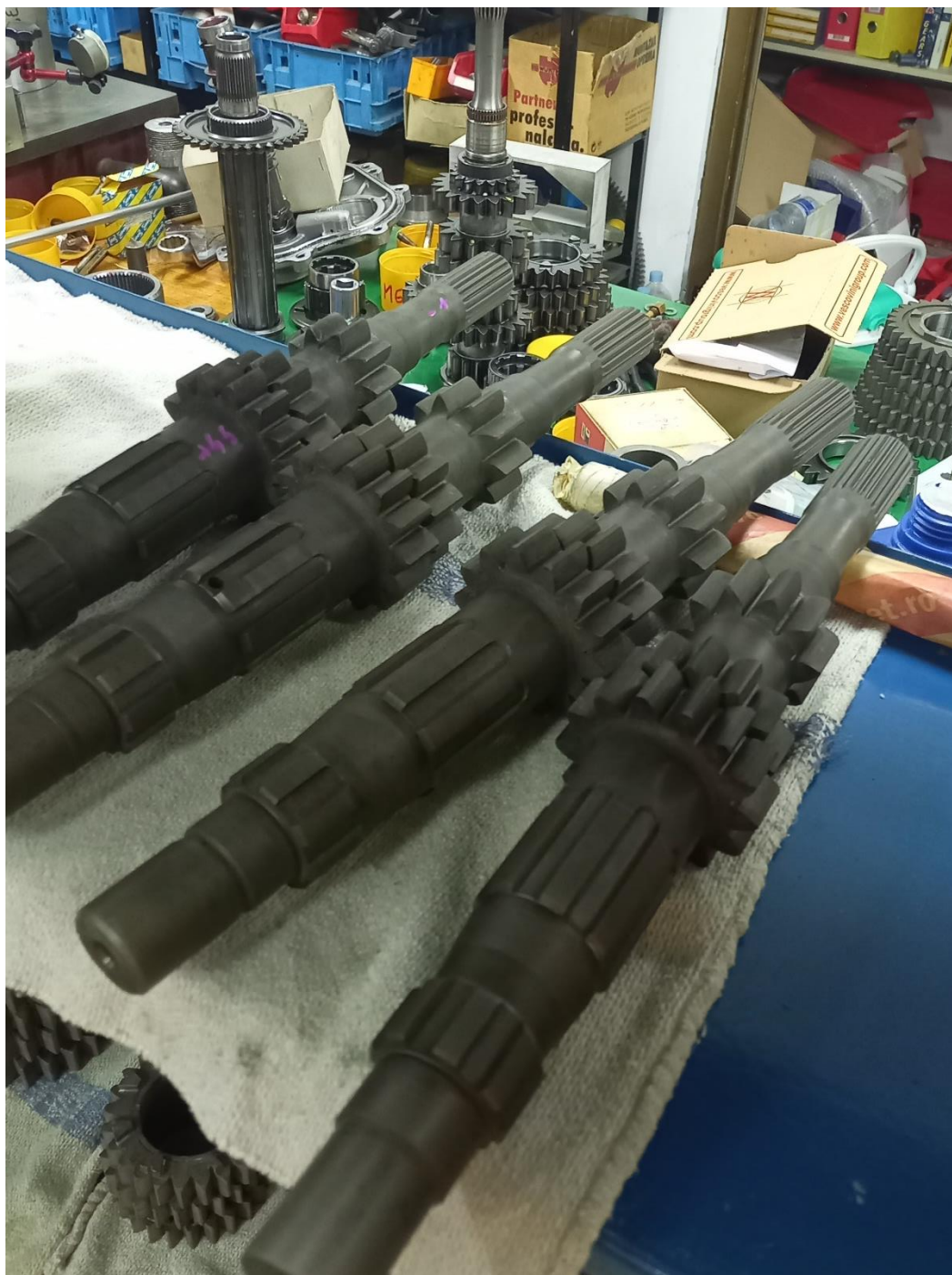
Slika 57. Vratila nakon toplinske obrade.
