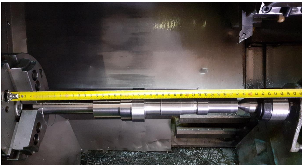
Slika 48. Grubo tokarenje u mekim čeljustima.
