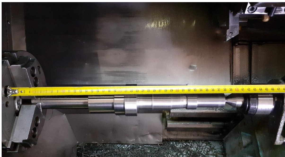
Slika 48. Grubo tokarenje u mekim čeljustima.
