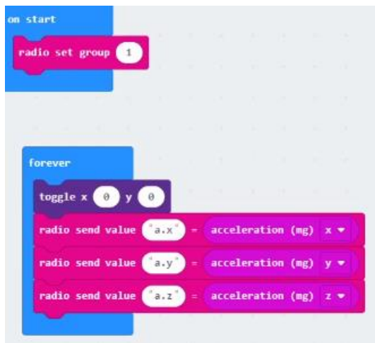
Slika 27. Kod udaljenog micro:Bit-a koji mjeri akcelerometrom
