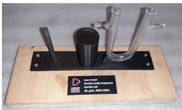
Slika 28. Zalijepljena U-cijev s dodanom brtvenom guminicom
