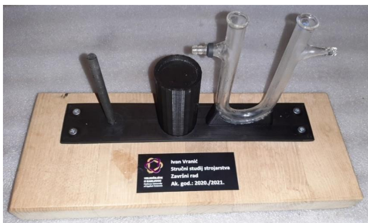
Slika 28. Zalijepljena U-cijev s dodanom brtvenom gumicom
