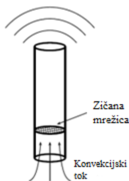
Slika 3. Shema Rijkeove cijevi [4]
