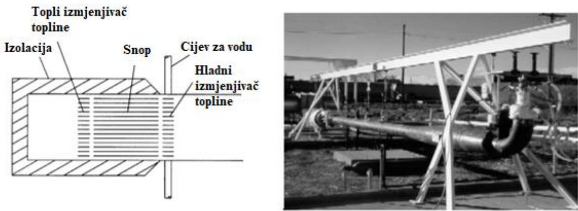
Slika 13. Termoakustični uređaj sa „stojnim“ valom [15]
