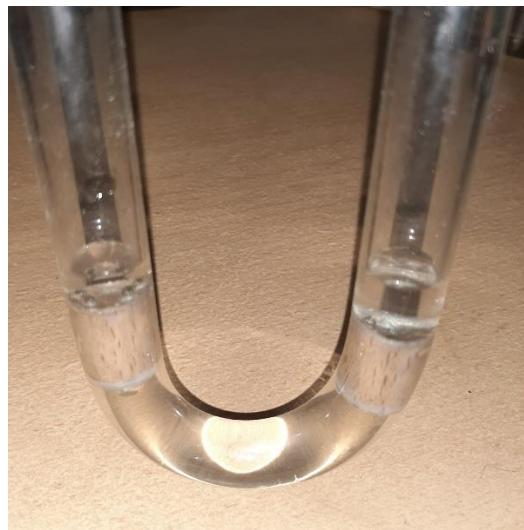
Slika 25. Klipovi zablokirani unutar U-cijevi
