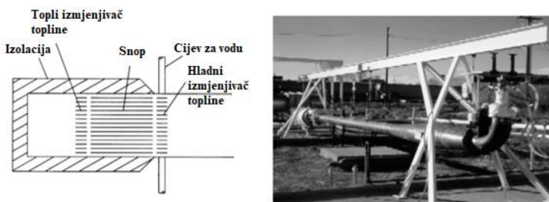
Slika 13. Termoakustični uređaj sa „stojnim“ valom [15]
