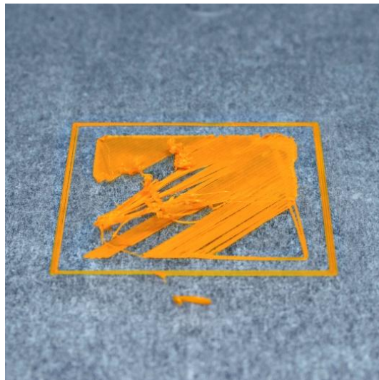
Slika 37. Prikaz lošeg prijanjanja materijala [37]
