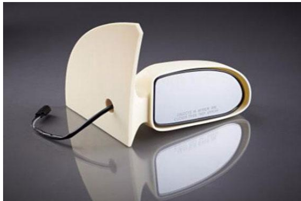
Slika 6. Model izrađen ASA materijalom
