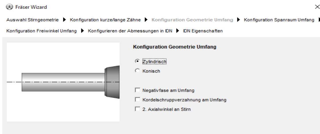
Slika 24. Konfiguracija geometrije promjera
