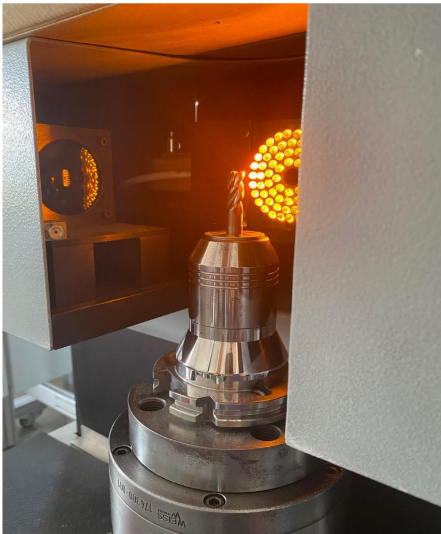
Slika 39. Rezni alat postavljen u uređaj za mjerenje i izračunavanje geometrijskih parametara
