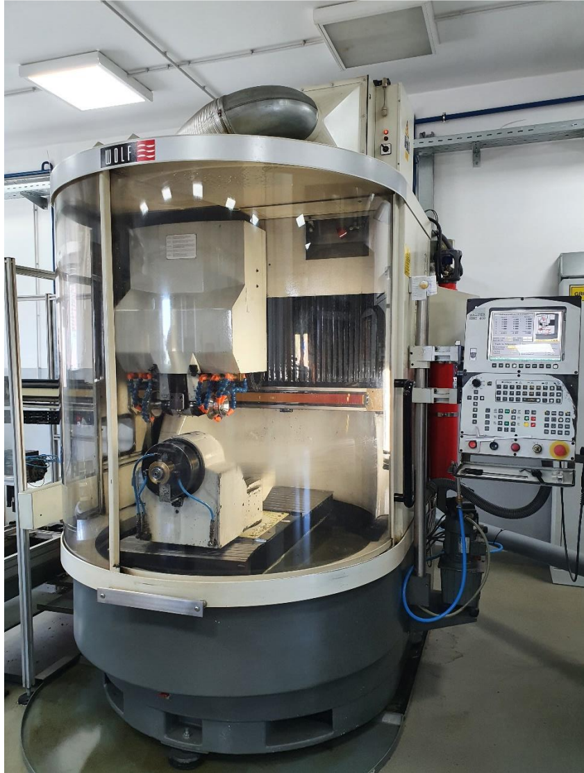
Slika 29. Pet osni CNC obradni centar Walter HMC 400
