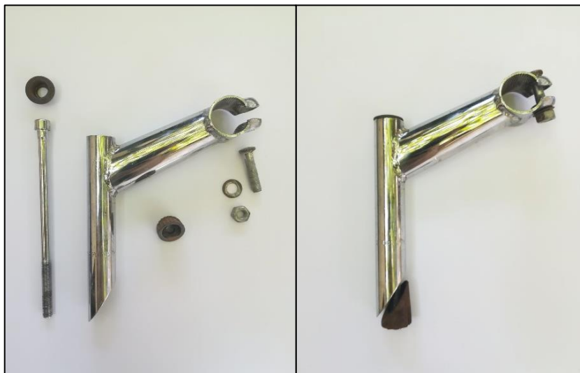
Slika 39 Lula u rastavljenom (lijevo) i sastavljenom (desno) obliku
