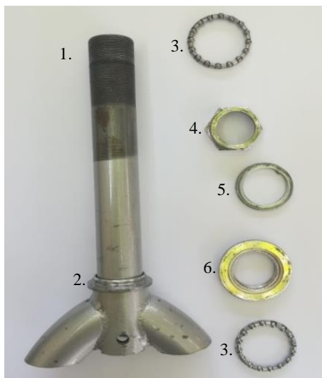
Slika 37 Cijev vilice bicikla koja se koristi za izradu prednje vilice električnog romobila
