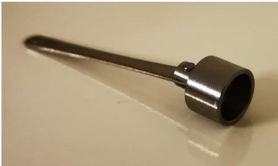
Slika 30. Radni klip s klipnjačom u Onshape CAD programu i komponenta makete [Izvor: rad autora]
