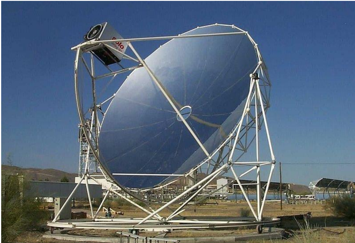
Slika 10. Solarni tanjur sa Stirlingovim motorom za napajanje [54]
