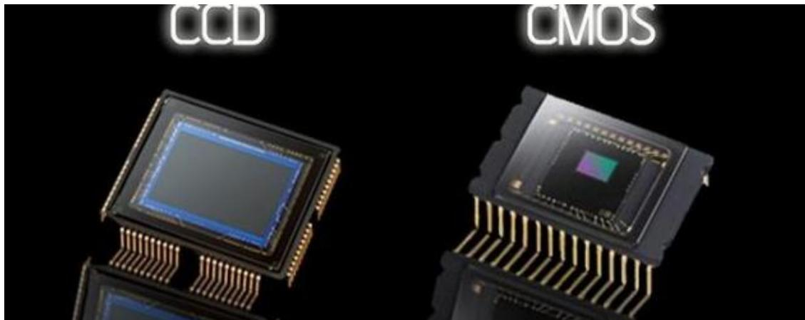
**Slika 16. CCD i CMOS senzor**
