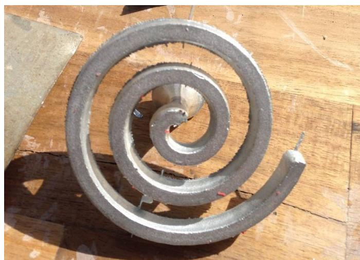
**Slika 66.** Odljevak nakon drugog lijevanja
