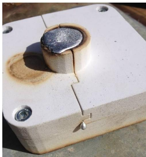
Slika 68. Smanjenje Kalupa 2 nakon trećeg lijevanja
