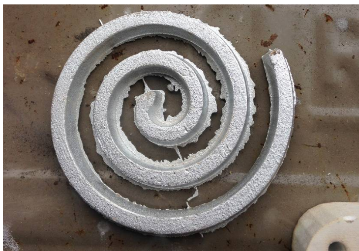
Slika 83. Odljevak nakon četvrtog lijevanja u kalup 3
