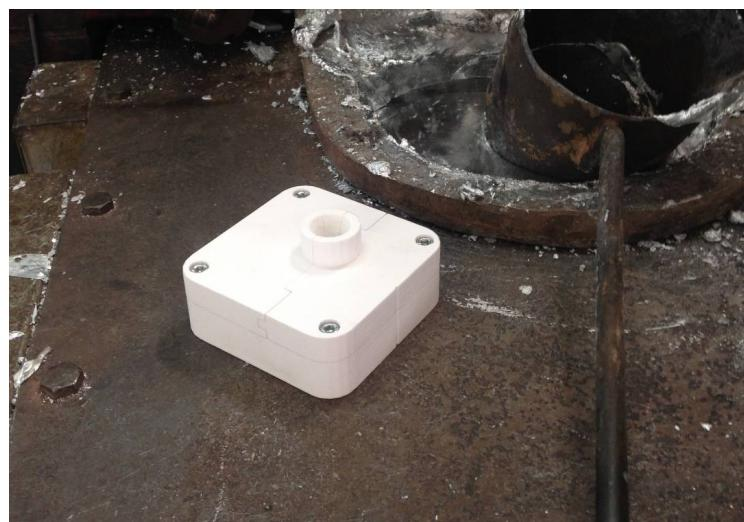
Slika 57. Zagrijavanje kalupa 2 na površini lijevačke peći
