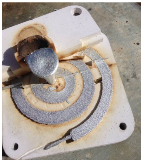
Slika 69. Pucanje Kalupa 2 prilikom vađenja odljevka
