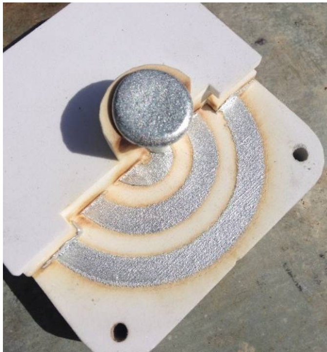
Slika 64. Micanje gornjeg lijevog dijela kalupa 2
