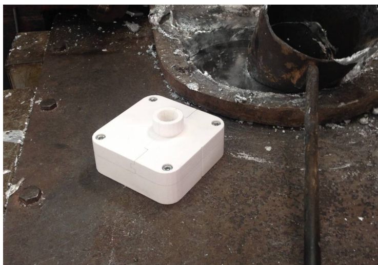
Slika 57. Zagrijavanje kalupa 2 na površini lijevačke peći
