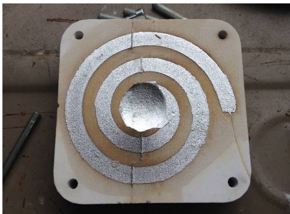
Slika 80. Odljevak nakon trećeg lijevanja u kalup 3
