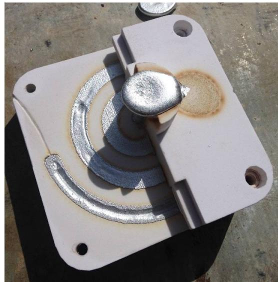
Slika 59. Micanje gornjeg desnog dijela kalupa 2 nakon lijevanja
