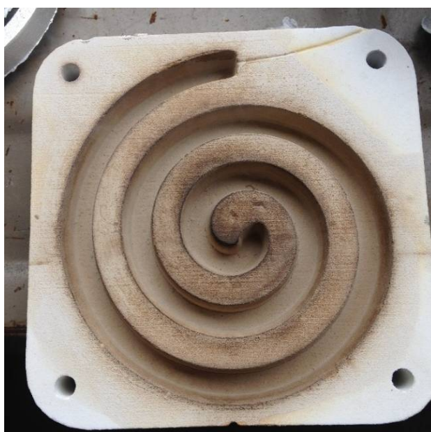
Slika 84. Kalup 3 nakon četvrtog lijevanja
