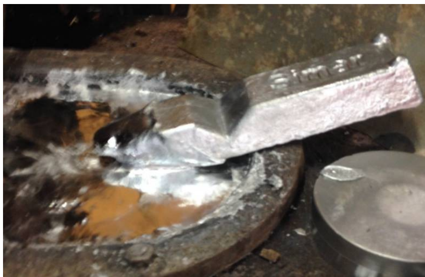
Slika 9. Taljenje legure Zamak 2 ( ZnAl_4Cu_3 )
