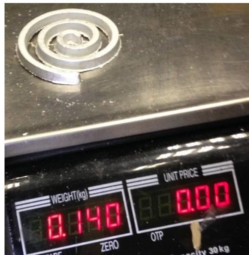
Slika 86. Masa odljevka nakon četvrtoj lijevanja u kalup 3
