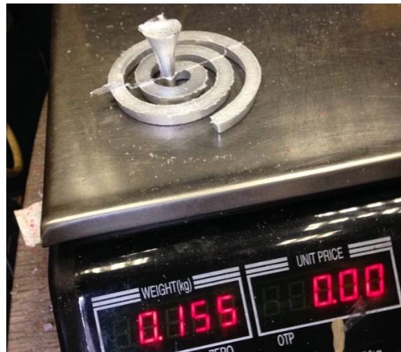
**Slika 79. Masa odljevka nakon drugog lijevanja u kalup 3**
