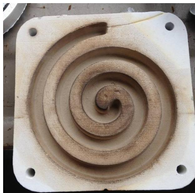
Slika 84. Kalup 3 nakon četvrto lijevanja
