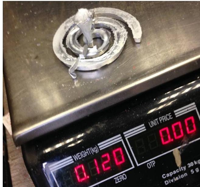
Slika 76. Masa odljevka nakon prvog lijevanja u kalup 3
