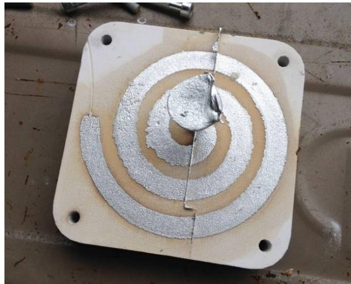
Slika 77. Odljevak nakon drugog lijevanja u kalup 3
