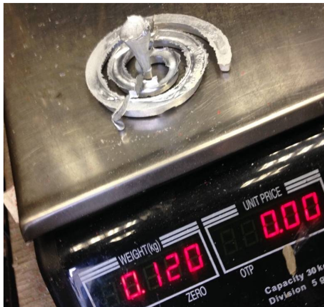
Slika 76. Masa odljevka nakon prvog lijevanja u kalup 3
