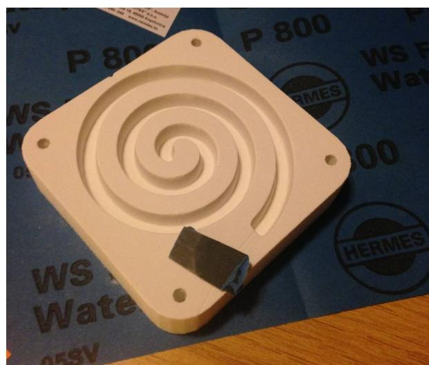
**Slika 71. Brušenje kalupa 3**
