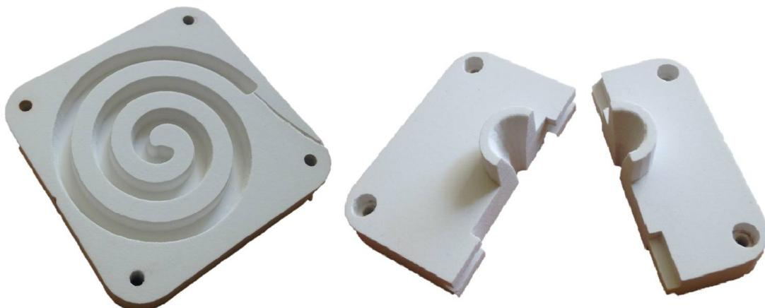
Slika 55. Isprintani dijelovi kalupa 2
