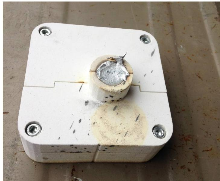
Slika 74. Kalup 3 nakon prvog lijevanja
