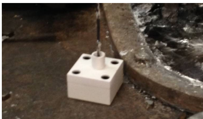
Slika 27. Zagrijavanje kalupa na ljevačkoj peći
