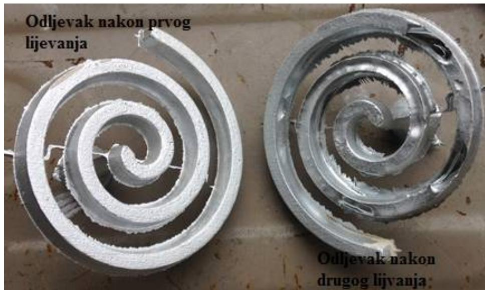
Slika 78. Razlika odljevaka prvog i drugog lijevanja u kalup 3
