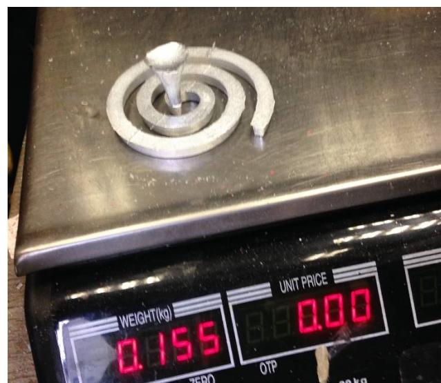
Slika 82. Masa odljevka nakon tećeg lijevanja u kalup 3
