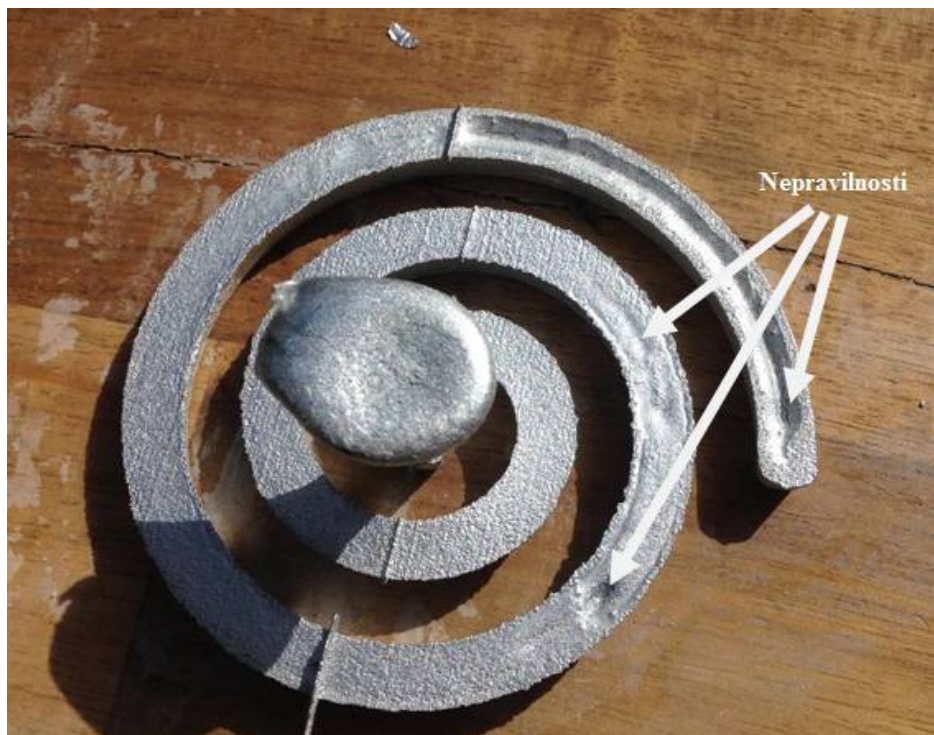
Slika 60. Nepravilnosti na odljevku prvog lijevanja
