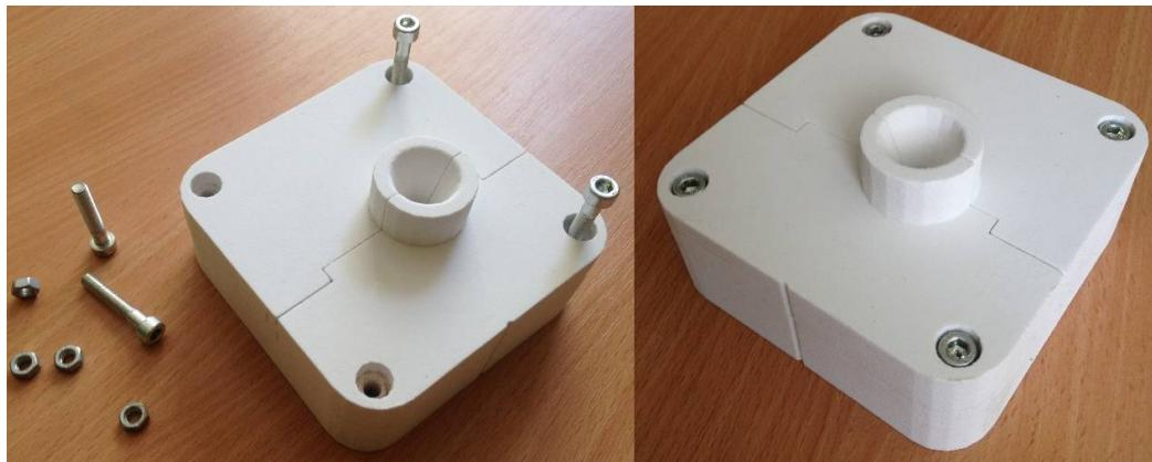
Slika 56. Sklapanje kalupa 2
