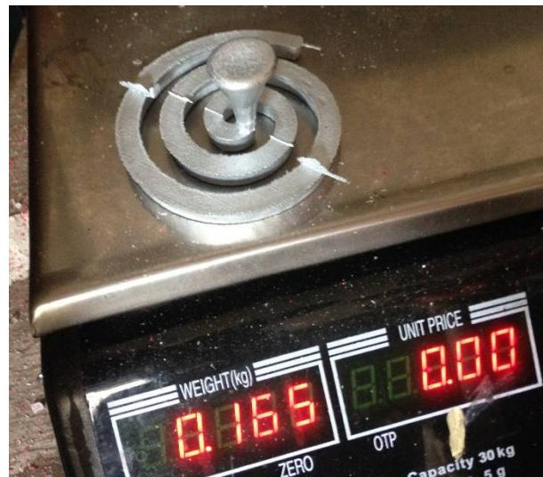
Slika 67. Masa odljevka nakon drugog lijevanja
