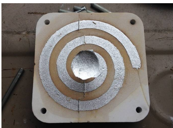
Slika 80. Odljevak nakon trećeg lijevanja u kalup 3
