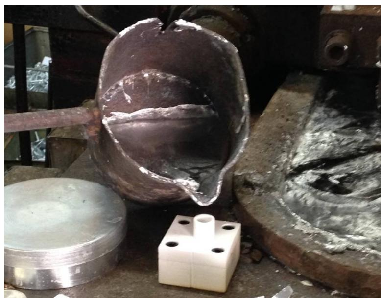
Slika 28. Ulijevanje litine Zamak 2 (ZnAl<sub>4</sub>Cu<sub>3</sub>) u kalup 1
