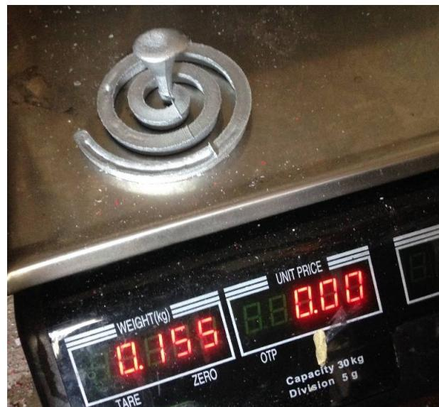
Slika 62. Masa odljevka nakon prvog lijevanja
