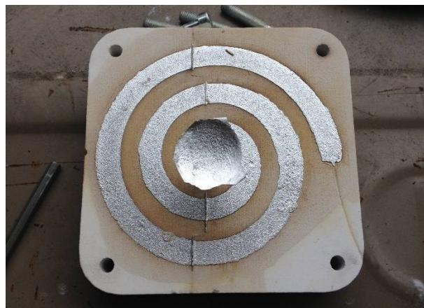
**Slika 80. Odljevak nakon trećeg lijevanja u kalup 3**
