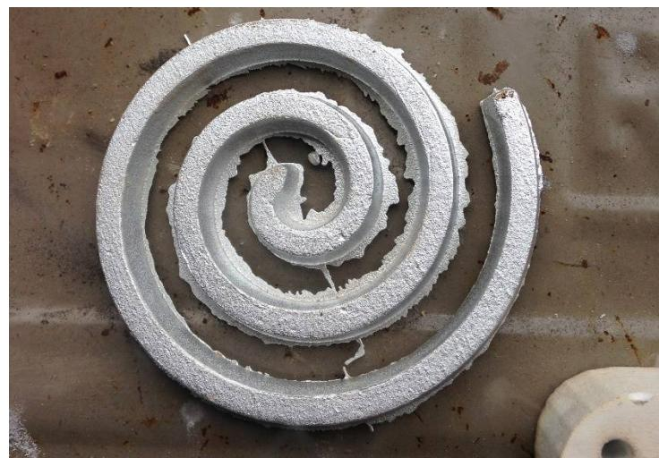
Slika 83. Odljevak nakon četvrto lijevanja u kalup 3
