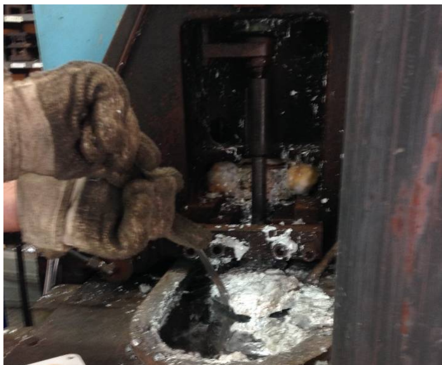
Slika 10. Odstranjivanje oslobođenih oksida sa površine taline
