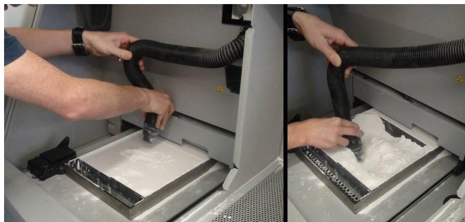
**Slika 7. Otklanjanje viška prašine nakon printanja**
