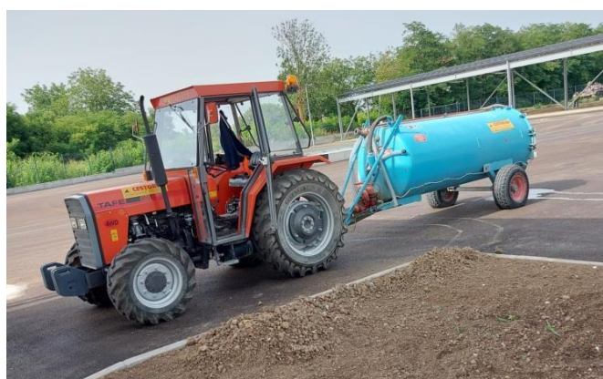
Slika 22. Traktor s cisternom za navodnjavanje
