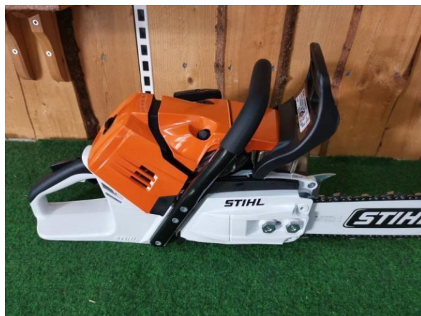
Slika 16. Motorna pila sa gumenom ručkom
