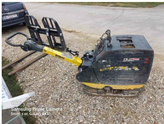
Slika 17. Vibracijska ploča „BOMAG“
