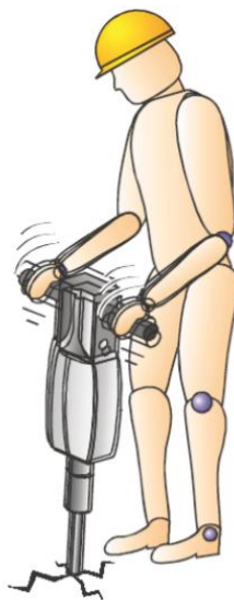
Slika 4. Prijenos vibracija putem sustava šaka-ruka
