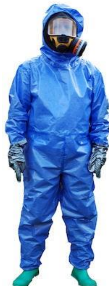
Slika 20: Primjer zaštitnog odijela pri radu s kemikalijama
