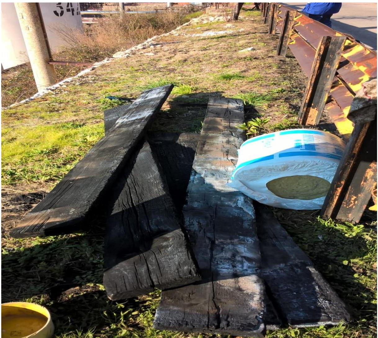
Slika 11. Požarom zahvaćene fosne sa skele iznad mesta požara [4]
