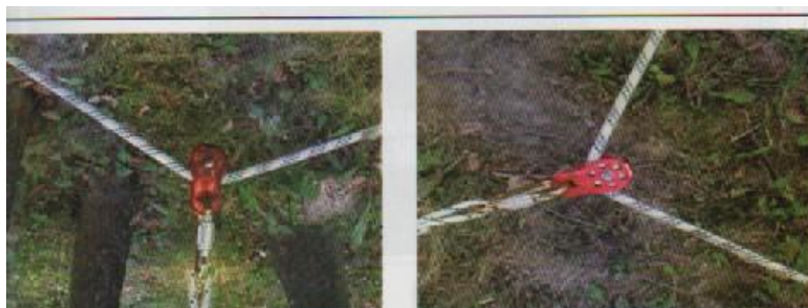
Slika 22. Primjer postavljanja devijatora [6]
