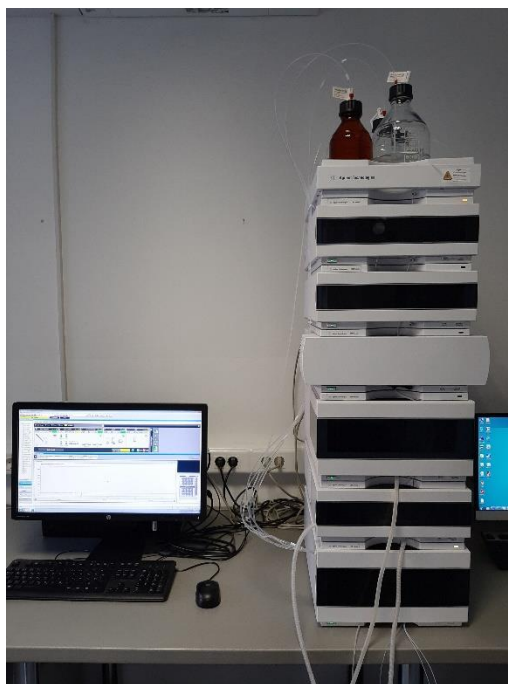
Slika 4. HPLC uređaj (Izvor: N. Ugarčina)
