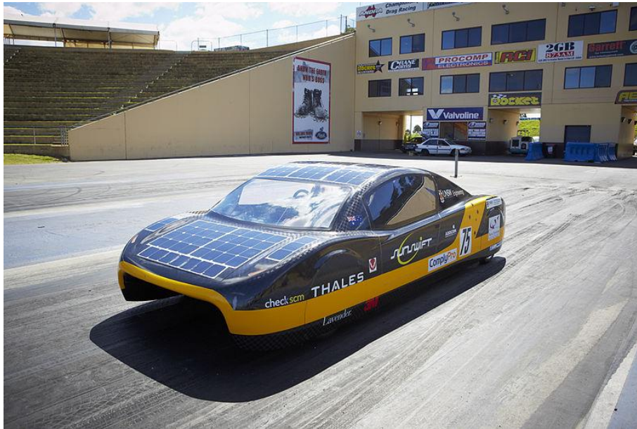
Slika 6. Solarni automobil eVe koji drži svjetski rekord, te je prvi Australijski solarni automobil odobren za cestu.
