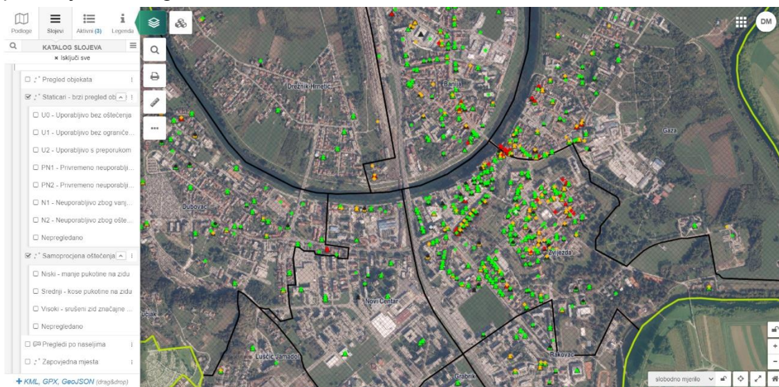
Slika 27 GIS prikaz objekata oštećenih u potresu – Karlovac[36]
